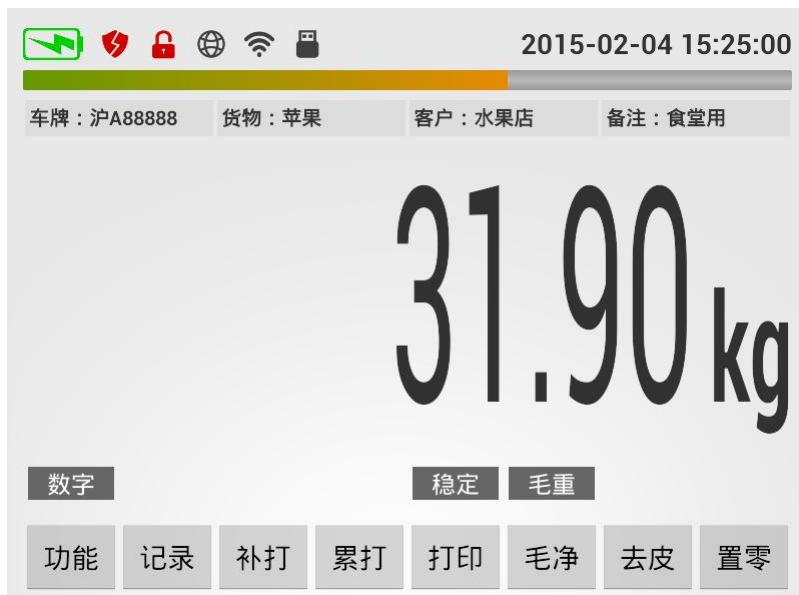
主界面顶部为状态栏，显示状态图标及当前时间。图标含义如下：
