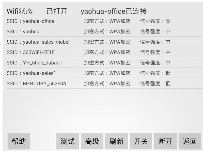
界面包括：无线状态显示区、搜索到的无线信号列表、无线设置操作。
